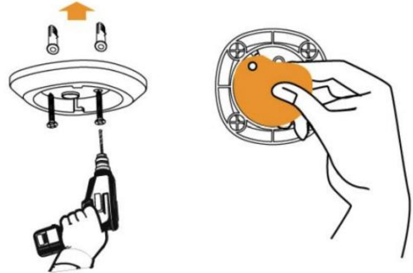
Fixer l'appareil et alimentez-le en retirant la languette
